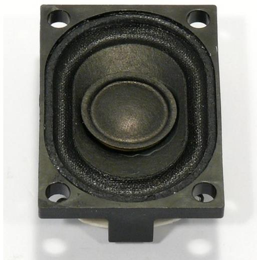
**2,8 x 4 cm (1,1" x 1,6") Kleinlautsprecher** mit Papier-membran und rechteckigem Kunststoffkorb. Geringe Baugröße aufgrund des Neodymantriebs. Durch das hervorragende Zusammenspiel der unterschiedlichen Komponenten wird ein sehr lineares Übertragungsverhalten erreicht. Der Anschluss erfolgt über rückseitig angebrachte Lötstellen.
